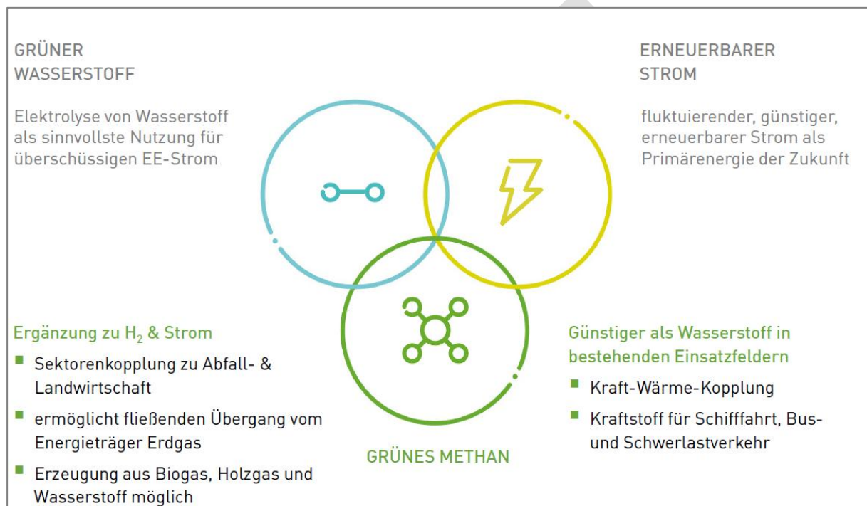
Abbildung 21 | Biomethan als Energieträger, Quelle: (Christian Löffler, 2022)
